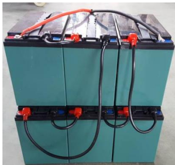
72V akkumulátorok kötése
