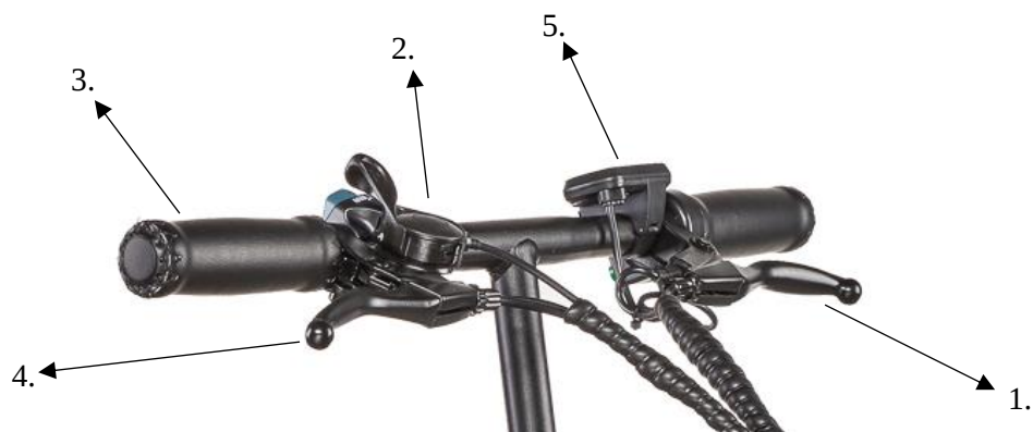
1. Bal oldali fékkar 2. Hangjelző 3. Fogantyú 4. Jobb oldali fékkar 5. Vezérlőpult
